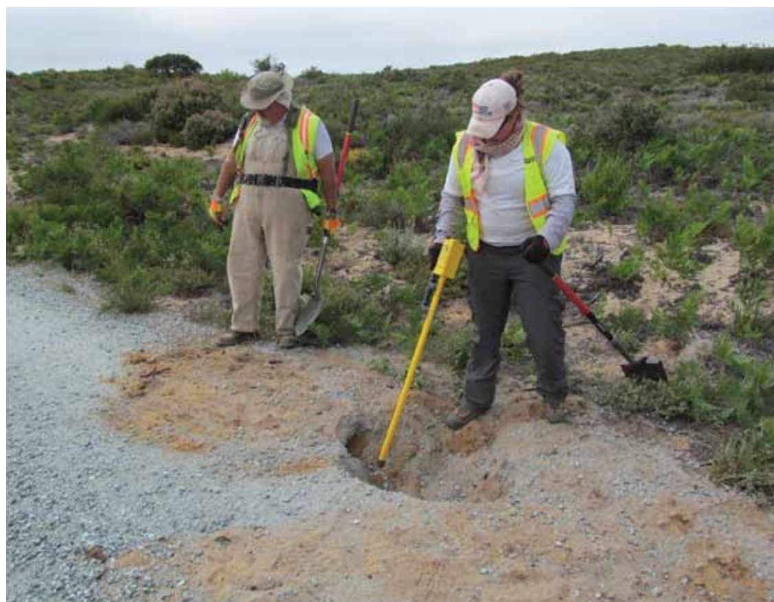
Trabajo de limpieza de municiones en 2011 usando un magnetómetro Schonstedt.
