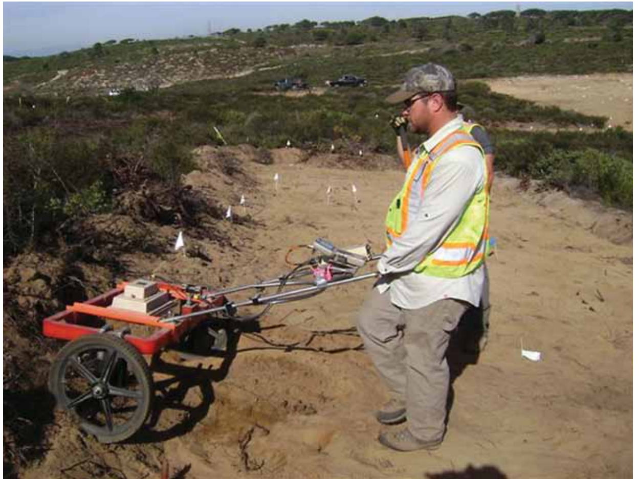
Trabajo de limpieza de municiones en 2011 usando un detector de metales electromagnético.
