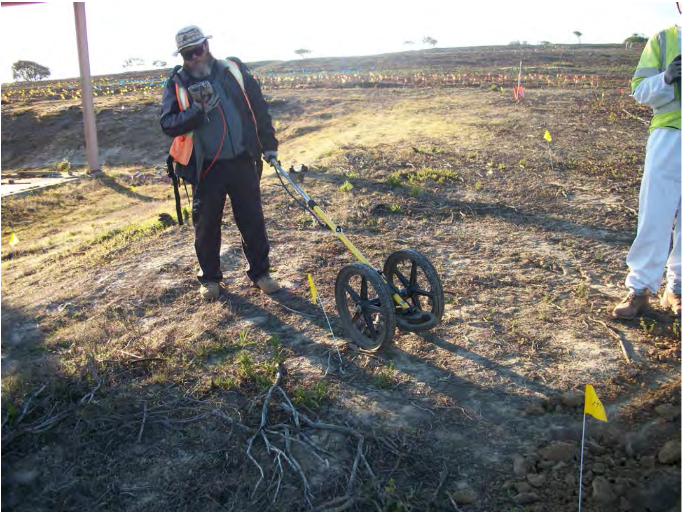
Picture 1: Anomaly locating utilizing the EM 61
